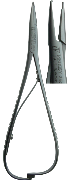
2825 mm 140 Pliers to place modules. Pinza per moduli. Pinza para modulos. Pinces à placer les modules. Un mors est équipé d'un bec, l'autre est évidé pour permettre de serrer la ligature élastomérique sans l'abîmer.
